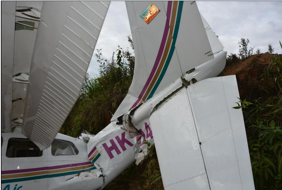
Fotografía No. 3: Daños en el fuselaje y estabilizador horizontal
