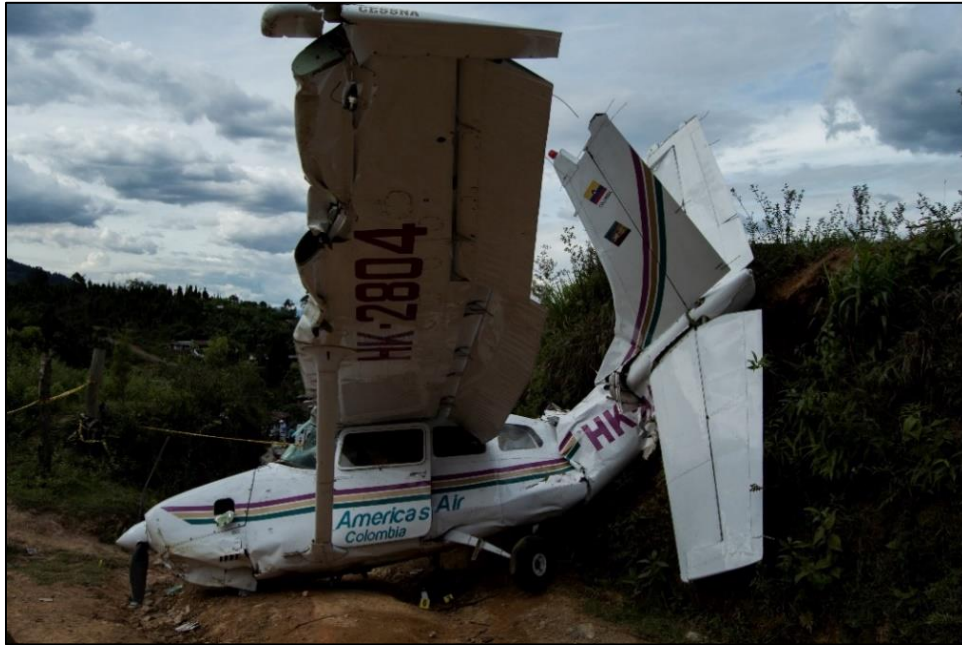
Fotografía No. 2: Daños en el plano izquierdo y en el fuselaje
