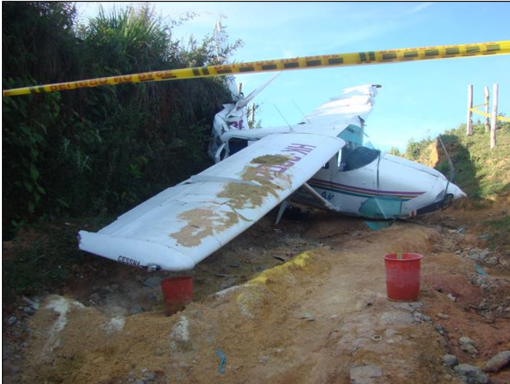
Fotografía No. 6: Procedimiento de recuperación del combustible con material absorbente / aserrín y agente químico.
